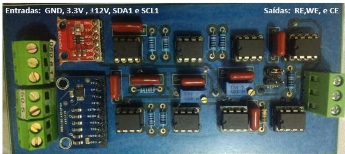
Figura 5- Potenciostato desenvolvido em laboratório.
