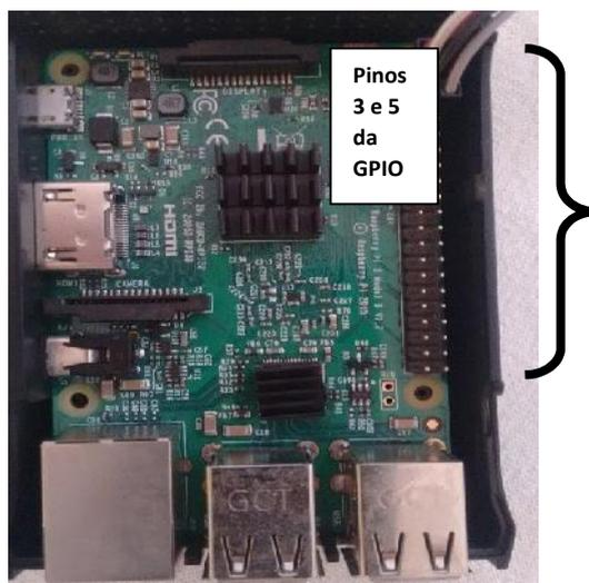
Figura 8 –Pinos SDA1 e SCL1 em uso – barramento I2C no Raspberry Pi B+.
