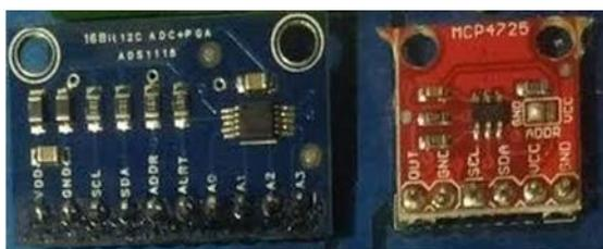
Figura 7 –Placa de entrada e saída analógica.
